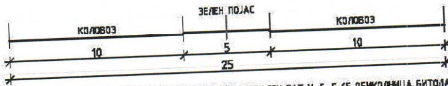
ПРЕСЕК 1 - 1 ПОПРЕЧЕН ПРОФИЛ НА ПЛАНИРАН МАГИСТРАЛЕН ПАТ М-5, Е-65 ОБИКОЛНИЦА БИТОЛА
