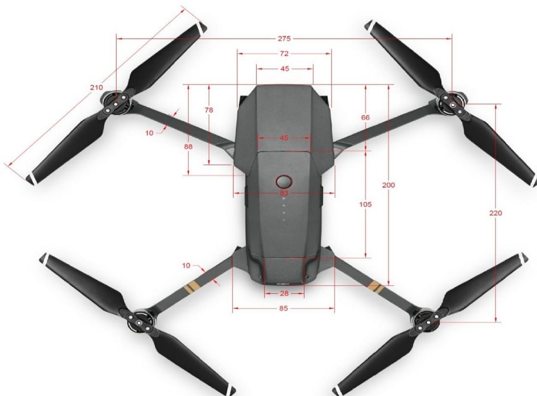
Слика 5. Димензии на составните делови на дронот (во mm) DJI Mavic Pro
