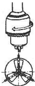
Сл.3.22: Во главата за стегање завојниот сврдел мора да се постави центрично.
