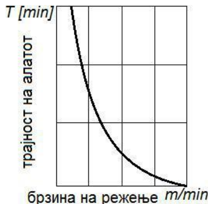
Сл.2.14: Зависност на трајноста на алатот од резната брзина.
