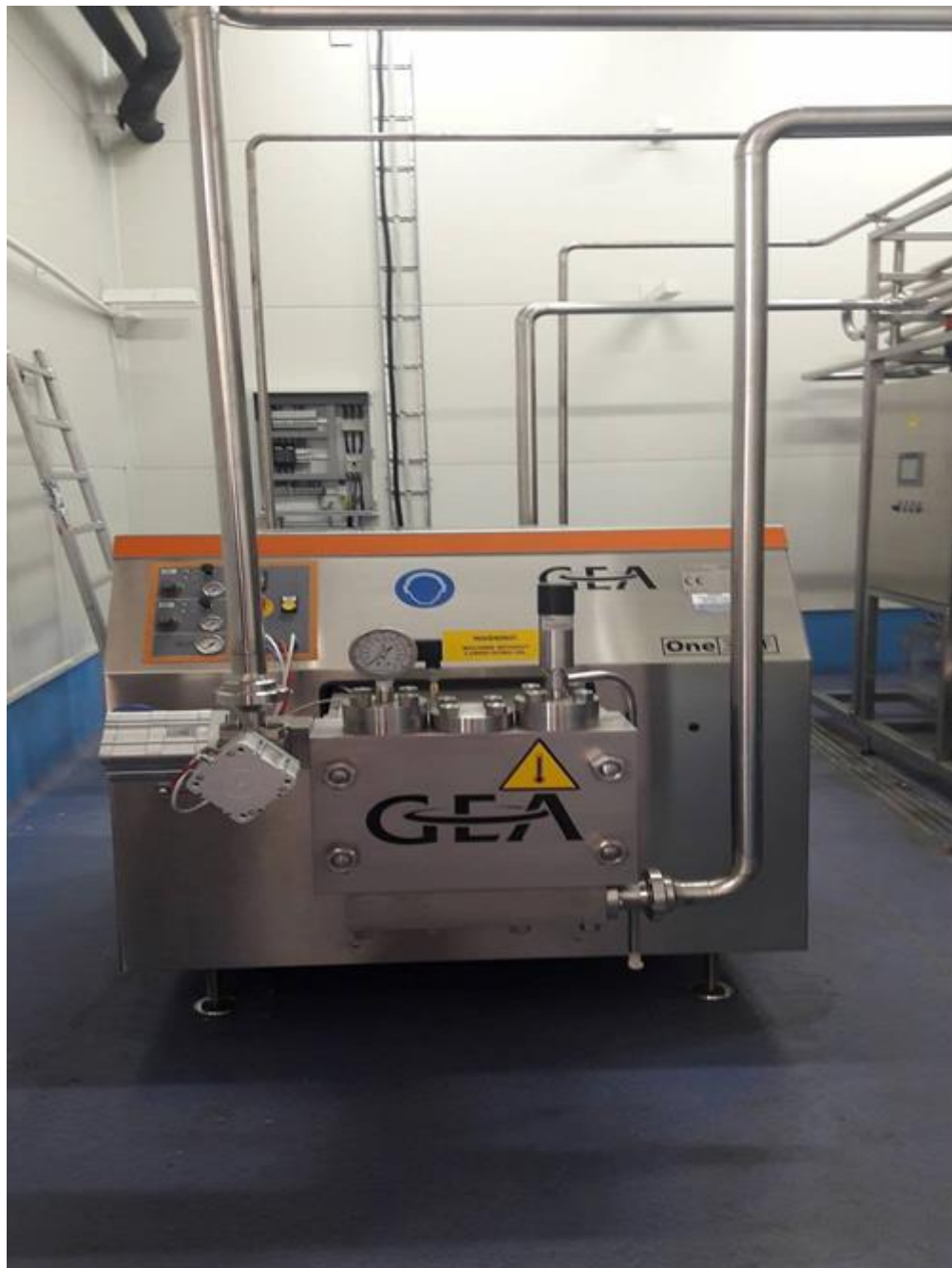
Слика 9 Хомогенизатор за млеко GEA ONE 37 TF
