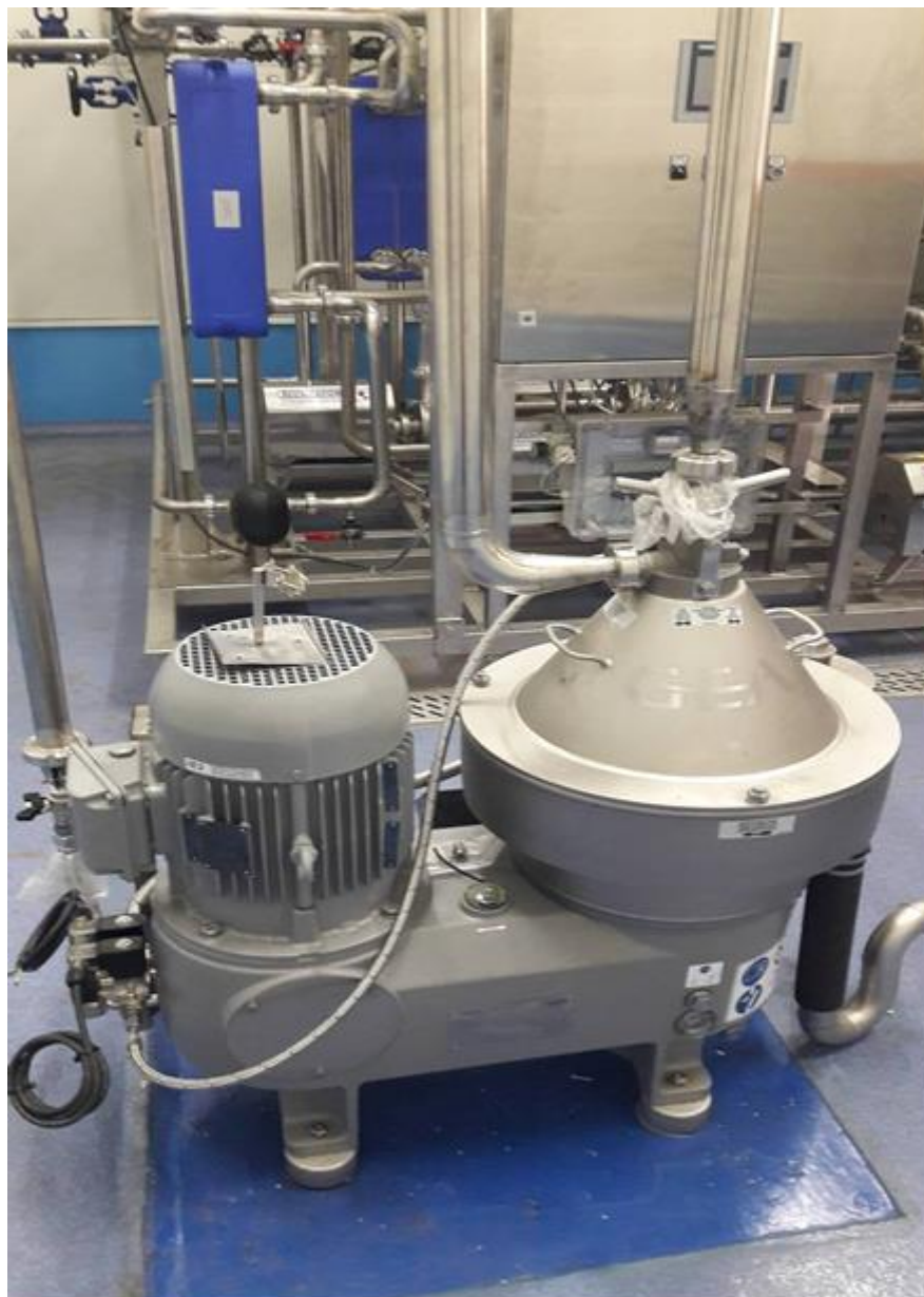
Слика 8 Сепаратор за млеко GEA Easycream Pro 3
